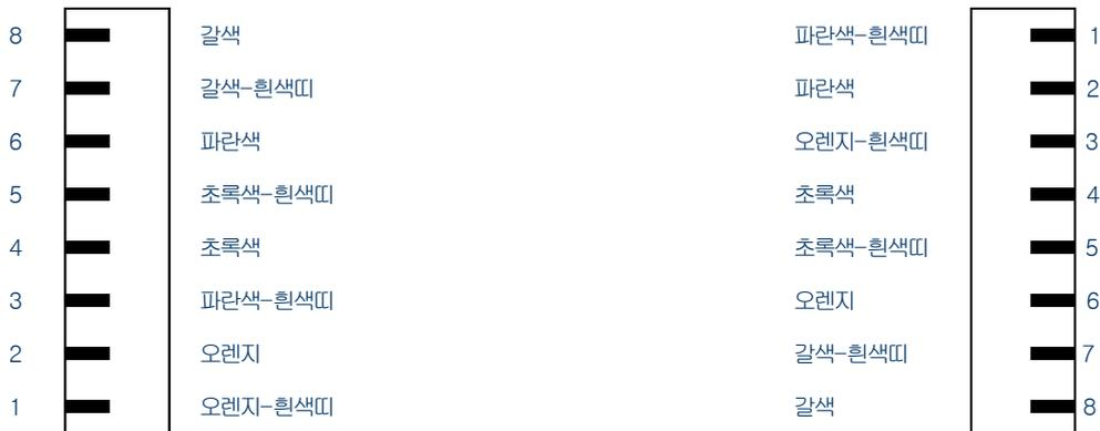
UTP케이블 제작시 연결하는 선의 색상은 사용자 임의대로 제작 가능합니다. 크로스 케이블 제작 시에도 RJ-45 커넥터의 1,2번은 송신 3,6번은 수신에 사용되는 선입니다. 양단의 송신부와 수신부의 선을 교차하여 연결합니다. 범용적으로 사용하는 선의 색상은 아래와 같습니다. 이더넷 프로토콜에서 권장하는 케이블의 최장길이는 100M입니다.
