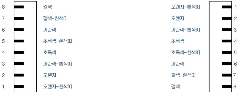
UTP케이블 제작시 연결하는 선의 색상은 사용자 임의대로 제작 가능합니다. RJ-45커넥터의 1,2번은 송신 3,6번은 수신에 사용되는 선을 연결하여야 합니다. 1:1 연결시 1,2번 3,6번의 선연결이 동일해야 하므로 주의하여 연결합니다. 범용적으로 사용하는 선의 색상은 아래와 같습니다. 이더넷 프로토콜에서 권장하는 케이블의 최장길이는 100M입니다.
